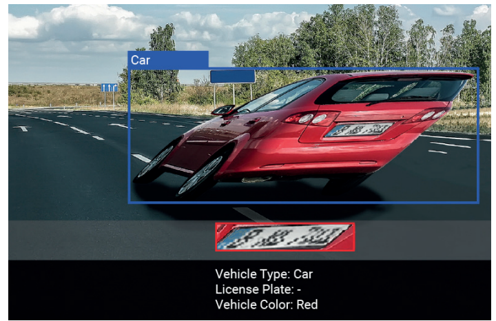
Abb. 8: Rolling Shutter: Nummernschild nicht auswertbar
