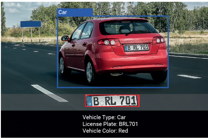
Abb. 7: Global Shutter: Nummernschild erkennbar
