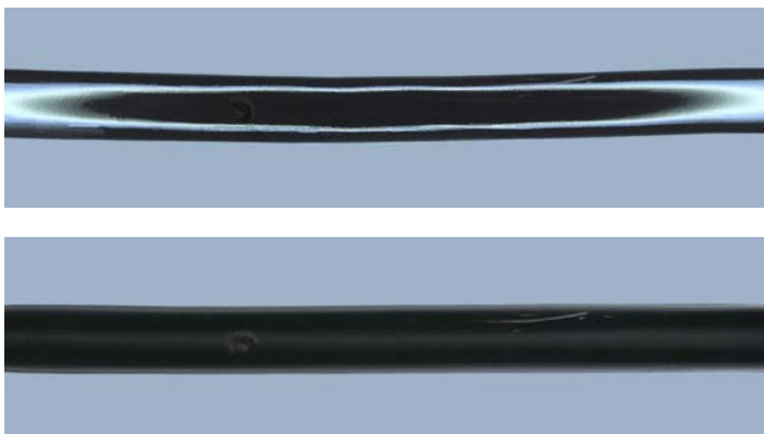
Abb. 1: Ausleuchtung im Vergleich: oben: Ringlicht; unten: Koaxiallicht
